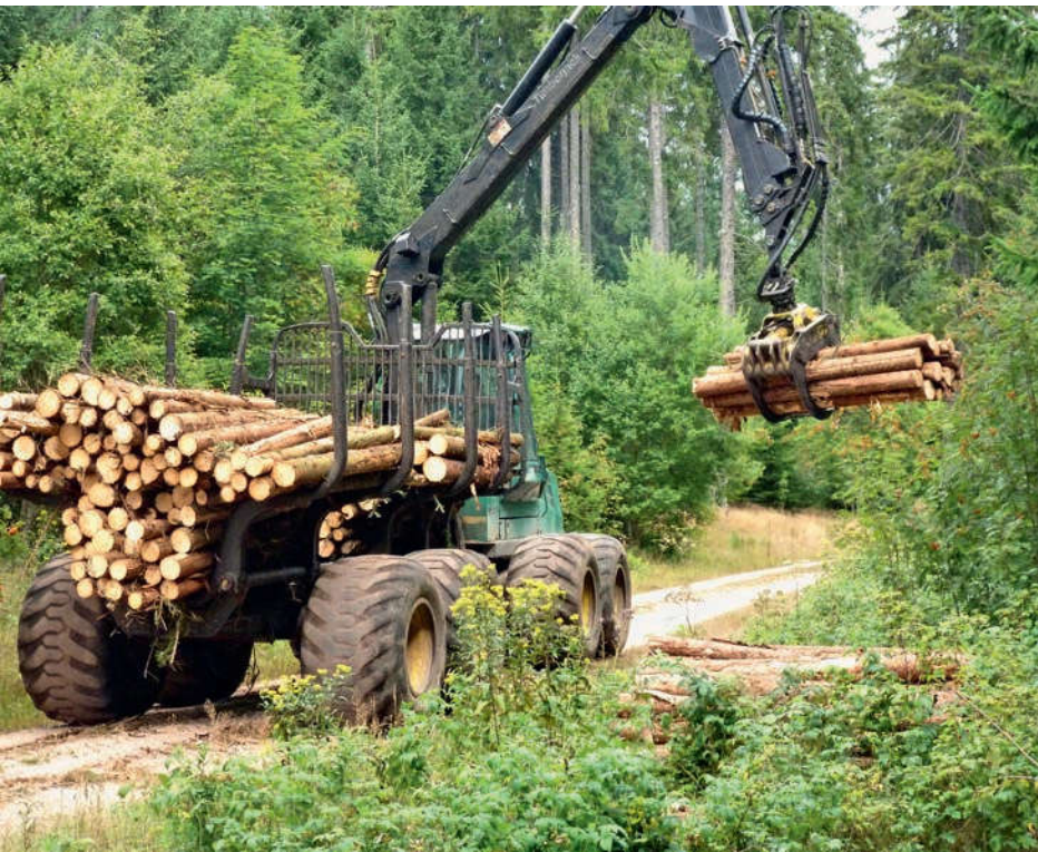
Angepasste Holzernteverfahren in naturschutzfachlich geprägten Beständen - bodenschonendes Rücken
