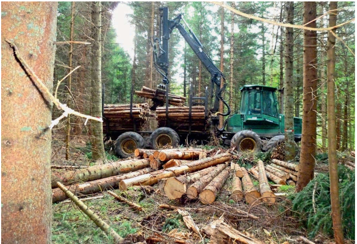
Angepasste Holzernteverfahren in naturschutzfachlich geprägten Beständen – Durchforstung - Aufarbeitung schwacher Sortimente
